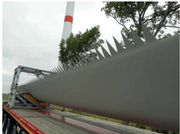
Abbildung 4: Transport und Handling der Rotorblätter sind durch deren Größe und Gewicht eine logistische Herausforderung in jedem Projekt. Inzwischen haben sie auch eine sog. Sägezahnabrisskante zur Senkung der Geräuschemission
