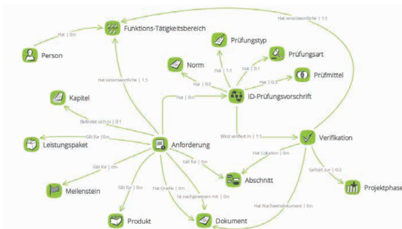
Abb. 1: Semantisches Informationsmodell (Anforderungsmanagement); Quelle: ARGE Fahrbahn Transtec Gotthard/Relatics
